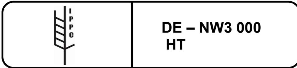
Beispiel 4 (Beispiel für eine Markierung, die mit einer Schablone aufgebracht wurde. Es können kleine Lücken in der Umrandung sowie der vertikalen Linie und an anderen Stellen zwischen den Komponenten der Markierung vorhanden sein.)
