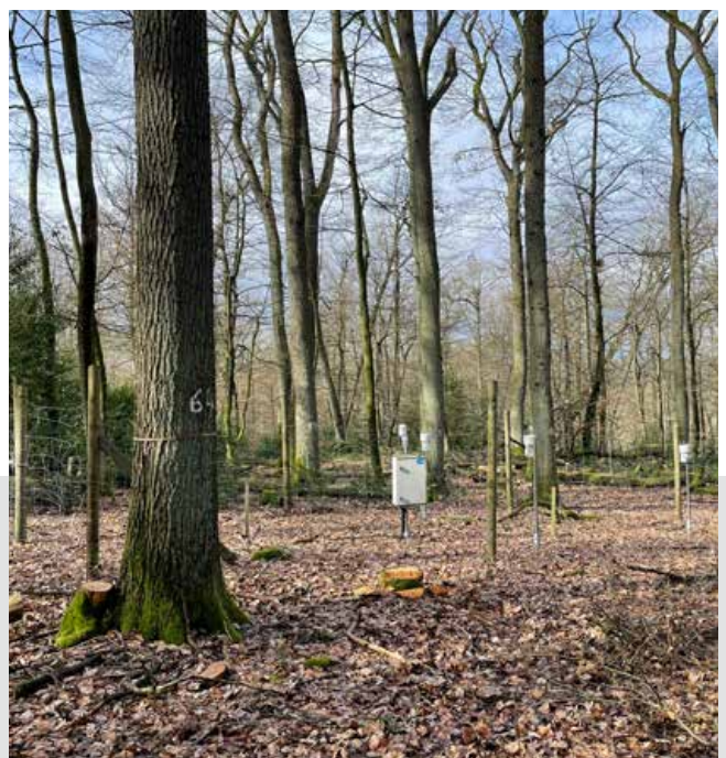
Bodenfeuchtemessstation auf der Level-II-Fläche Arnsberg
