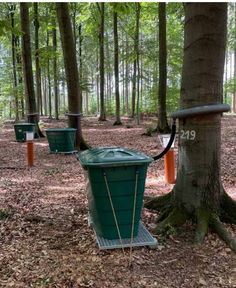
Stammabflussmessung auf der Level-II-Fläche Rott/Eifel
