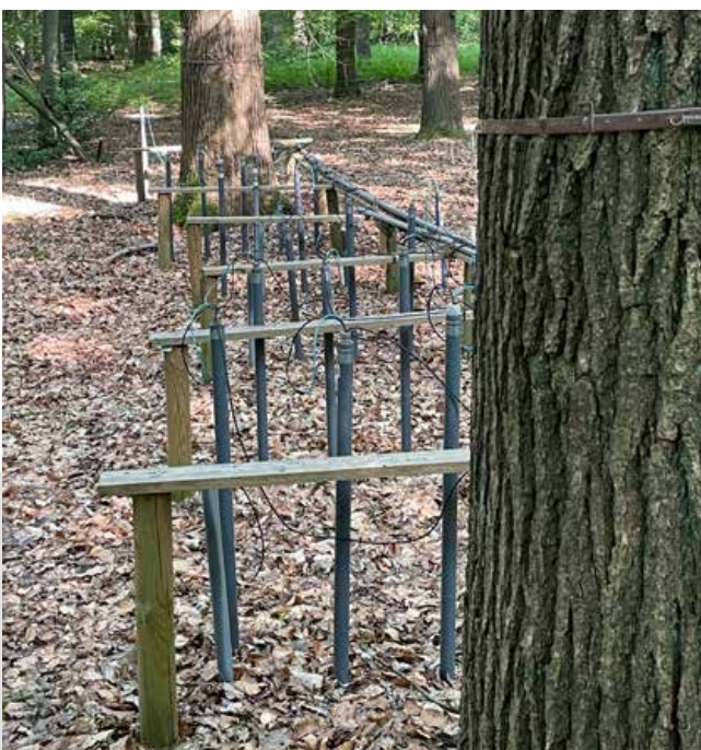
Messung der Bodenwasserspannung mit Tensiometern auf der Level-II-Fläche Kleve-Tannenbusch
