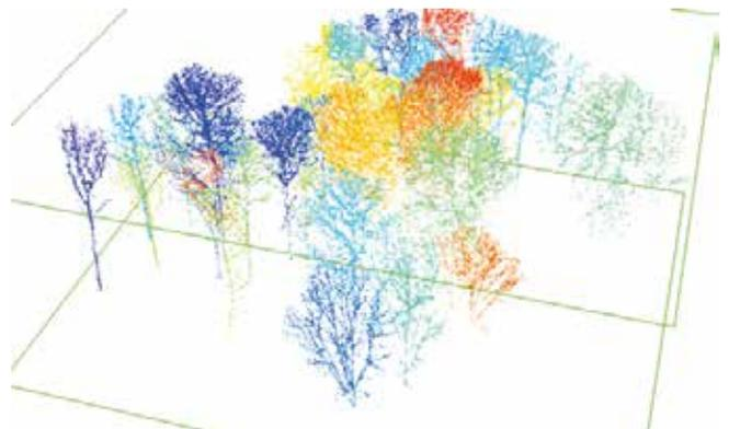
Abbildung 24: Ausschnitt Höhenmodell der NWZ 43 erstellt mit Daten eines Drohnenüberflugs (DJI Matrice 600 Pro und Laserscanner Velodyne Puck Life) Dezember 2020
