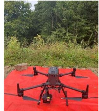
Abbildung 1: Drohne - DJI Matrice 300 RTK mit der Zenmuse H20T
