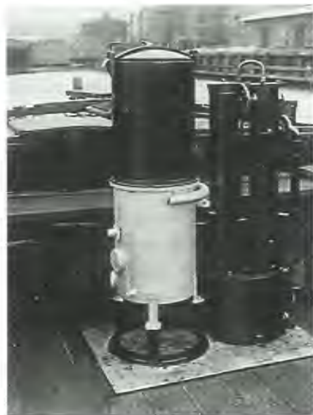
Holzvergaseranlage in einem Frachtkahn (Photo: Archiv Inst. f. Forstbenutzung, Göttingen)
