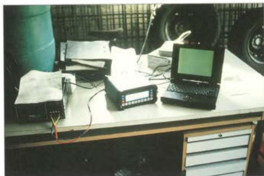
Abb. 2: Außer der Antenne gehören zur Feststation ein GPS-Receiver, der die von der Antenne empfangenen Signale auswertet, und ein Computer, der diese Daten kontinuierlich speichert.
