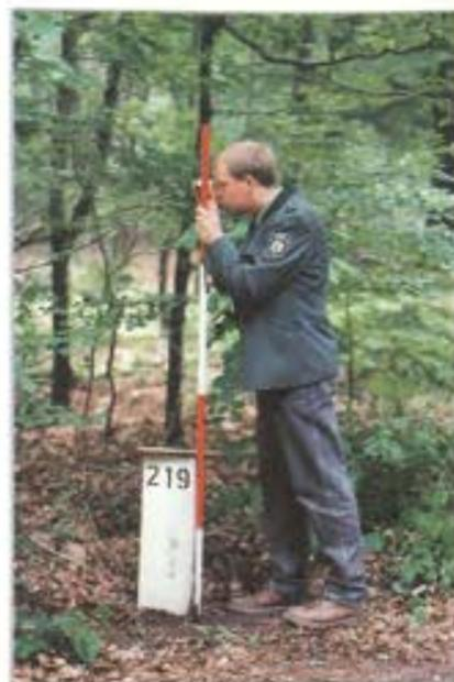
Abb. 2: Vom Anbindungspunkt wird der Stichprobenmittelpunkt eingemessen
