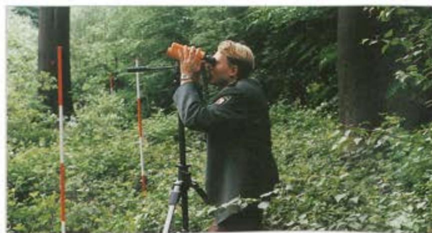
Abb. 8: Höhenmessung mit dem Laserdendrometer
