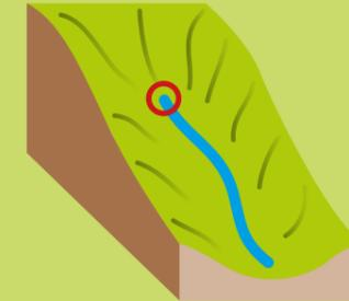
**Sickerquelle:** Sie tritt diffus an mehreren Stellen aus, zum Beispiel flächig-sickernd aus Waldboden auf geneigtem Gelände
