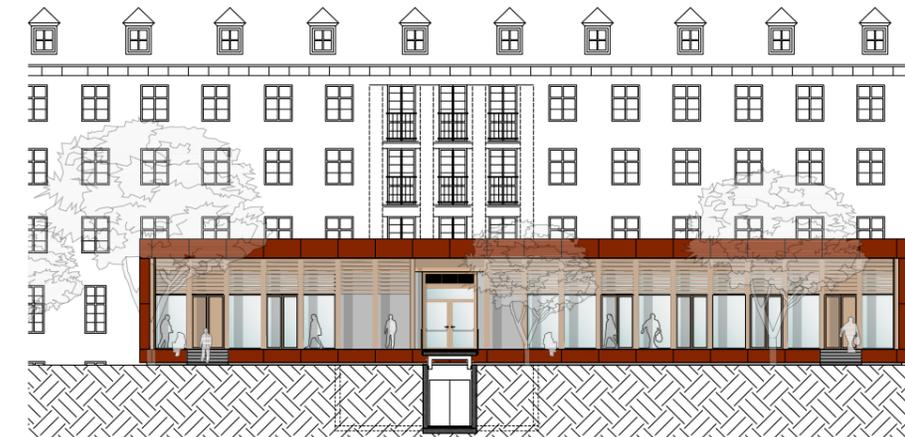
Die konstruktive Verschattung über das hervorstehende Dach, feststehende Lamellen im oberen Drittel der Südfassade und Sonnenschutzjalousien blenden die direkte Strahlung der hochstehenden Sonne aus und machen die Nutzung des diffusen Lichtes möglich.
