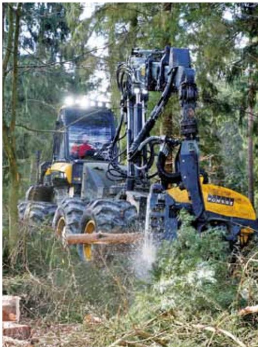
Viele Reifen, breite Reifen, lastabhängiger Reifeninnendruck. Forsttechnik bei Wald und Holz NRW konzentriert sich bei der bodenschonenden Holzernte mit Harvestern primär auf eine Verringerung des Kontaktflächen-drucks.
