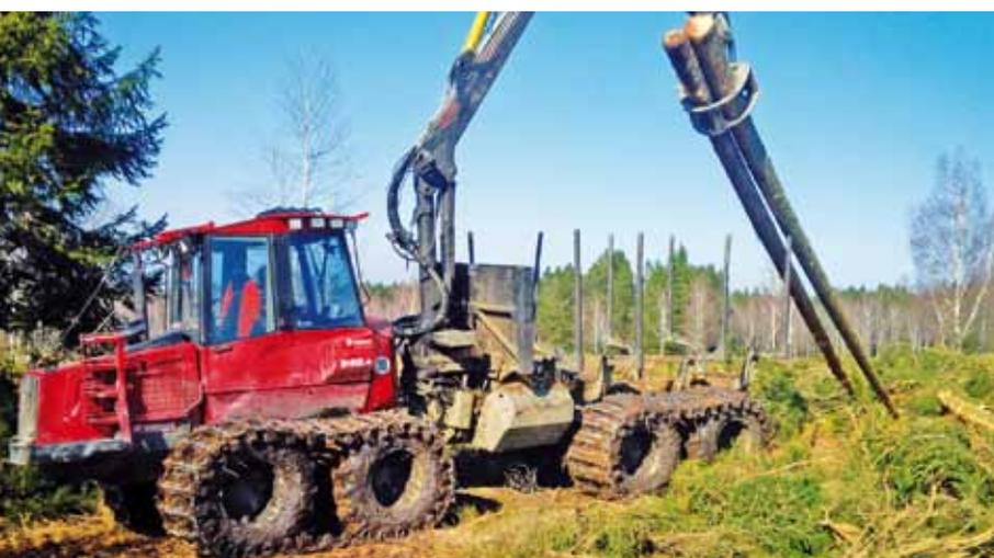
Bei der Entfichtung im Feuchtheidegebiet des Naturschutzgebietes Struffelt kommen Moorbänder auf dem Hinterwagen des Forwarders zum Einsatz. Sie verhindern auf Grund der breiten Stahlplatten ein Einsinken der bei maximaler Zuladung 30 Tonnen schweren Forstmaschine in den feuchten Boden.
