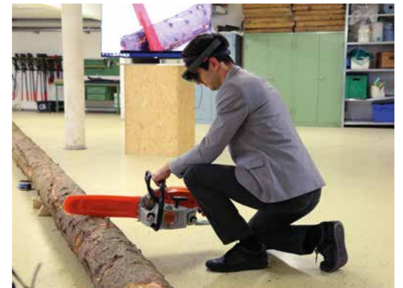
Abb. 3: Einteiloptimierung mittels Mixed Reality: Die Brille zeigt, wo die Säge ansetzen soll. Der Monitor im Hintergrund zeigt das Bild aus der Brille des Motorsägenbedieners. Diesem werden die Schnittmarken der einzelnen Sortimente am realen Baumstamm angezeigt, sodass die Bearbeitung passgenau und ohne manuelles Vermessen für eine konkrete Bestellung erfolgen kann.
